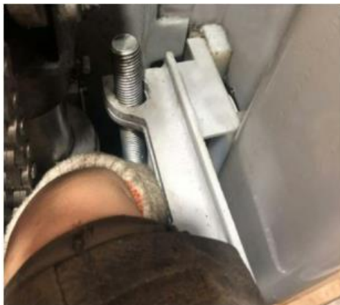
Fig9 Fijar en el agujero y atornillar los equipos, misma instalación de dos lados.
