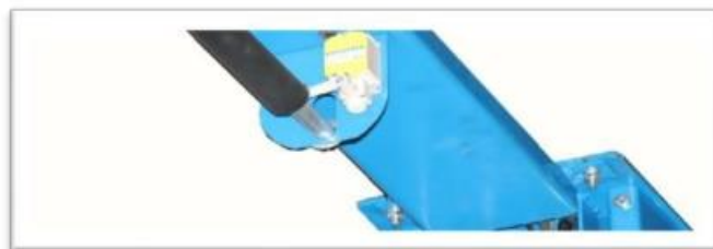
Fig. 15 La muesca de la ranura está hacia arriba, la tubería de aceite y el cable eléctrico pasan a través de la ranura y se fijan con un clip de fijación, el interruptor de límite se instala en la placa fija cerca de la dirección de la estación de bombeo.
