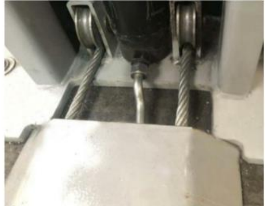
Fig. 12 Instalación de la cubierta de la tubería, déjela fijada cerca de la base.
