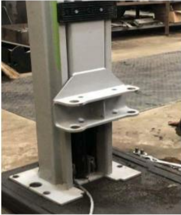
Fig5 Coloque los postes y las correderas de elevación a 400 mm-500 mm de alto (dos pilares es lo mismo)
