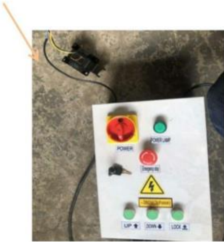
Fig8-1 Esta línea fija el otro electroimán
